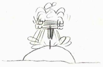
Dies ist die herkömmliche Art, Steine zu spalten. Man beginnt mit dem Bohren eines Loches.
