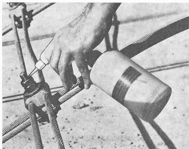
in den Gewindegängen wird eine Sicherungswirkung bis zu 13 m kp erreicht. Vertrieb: Loctite Deutschland, D-8000 München 81, Arabellastrasse 5. DK 621.882.5
