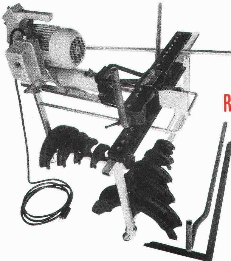
Die neue Ausführung des oberen, patentierten Gleitbügels ermöglicht das Biegen von **Bogen an Bogen**.
