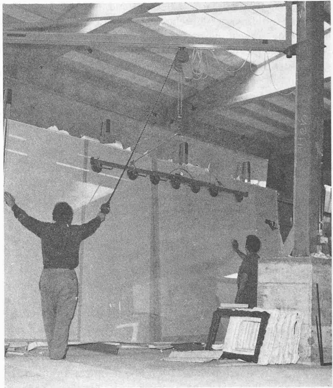
Bild 3. Handhabung grosser Glastafeln mit Kran und Sauger
