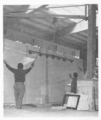
Bild 3. Handhabung grosser Glastafeln mit Kran und Sauger
