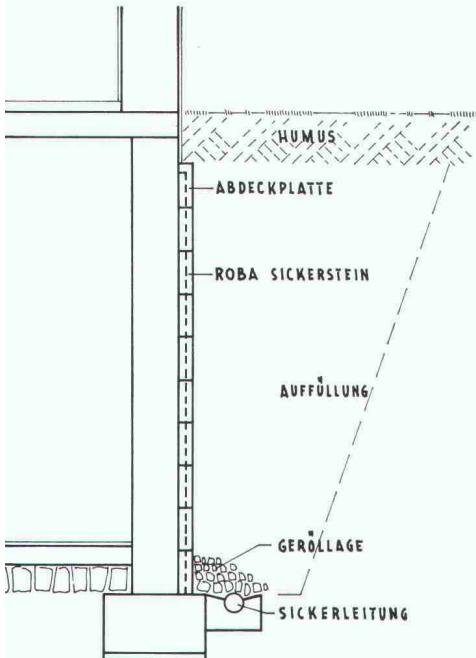
Typen: Sickerstein und Abdeckplatte
