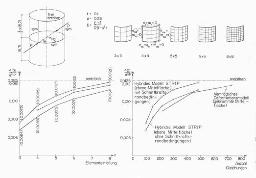
Bild 10. Durchbiegung unter zwei Einzellasten, die auf einen frei drehbar gelagerten Zylinder wirken. Die Ergebnisse des Hybriden Modelles (ebene Mittelfläche) mit Schnittkraftsrandbedingungen sind genauer als jene des gleichen Modelles ohne; diese schneiden aber besser ab als die Ergebnisse eines verträglichen Deformationsmodelles mit gekrümmter Mittelfläche
