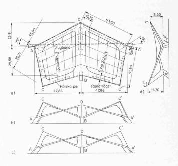
Bild 18. Übersichtsplan des Hyparschalendaches. a) Grundriss, b) Ansicht von B, c) Ansicht von D, d) Ansicht von A bzw. A' (aus [45])
