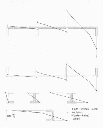
Bild 14. Vergleich der Quermomentenverteilung in Feldmitte des Hohlkastenträgers, bestimmt mittels einer Finiten Element-Berechnung und aus einer Fourierreihe
