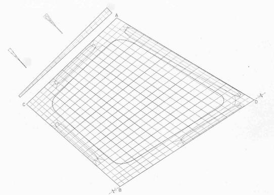
Bild 19. Elementeinteilung der eigentlichen Schale und der Randträger. Beim Übergang des Voll- zum Hohlquerschnitt sind die Ecken der Finiten Elemente der Ober- und Unterseite des Randträgers exzentrisch an die in der Fortsetzung der Mittelfläche der Schale liegenden Knoten des Vollquerschnittes angeschlossen worden
