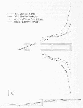
Bild 15. Die Übereinstimmung der Normalspannungen im Einspannquerschnitt des Hohlkastenträgers der Finiten Element-Berechnung als Schale mit jenen aus einer Fourierreihe ist gut. Zum Vergleich ist das Ergebnis der Berechnung mit Finiten Elementen als Membran und dasjenige der Balkentheorie mit gemischter Torsion aufgetragen
