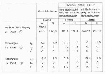
Bild 5. Das Einführen statischer Randbedingungen im Hybriden Modell, d. h. deren Einbau in den Schnittkraftansatz, verbessert im Falle der Kragscheibe die Ergebnisse
