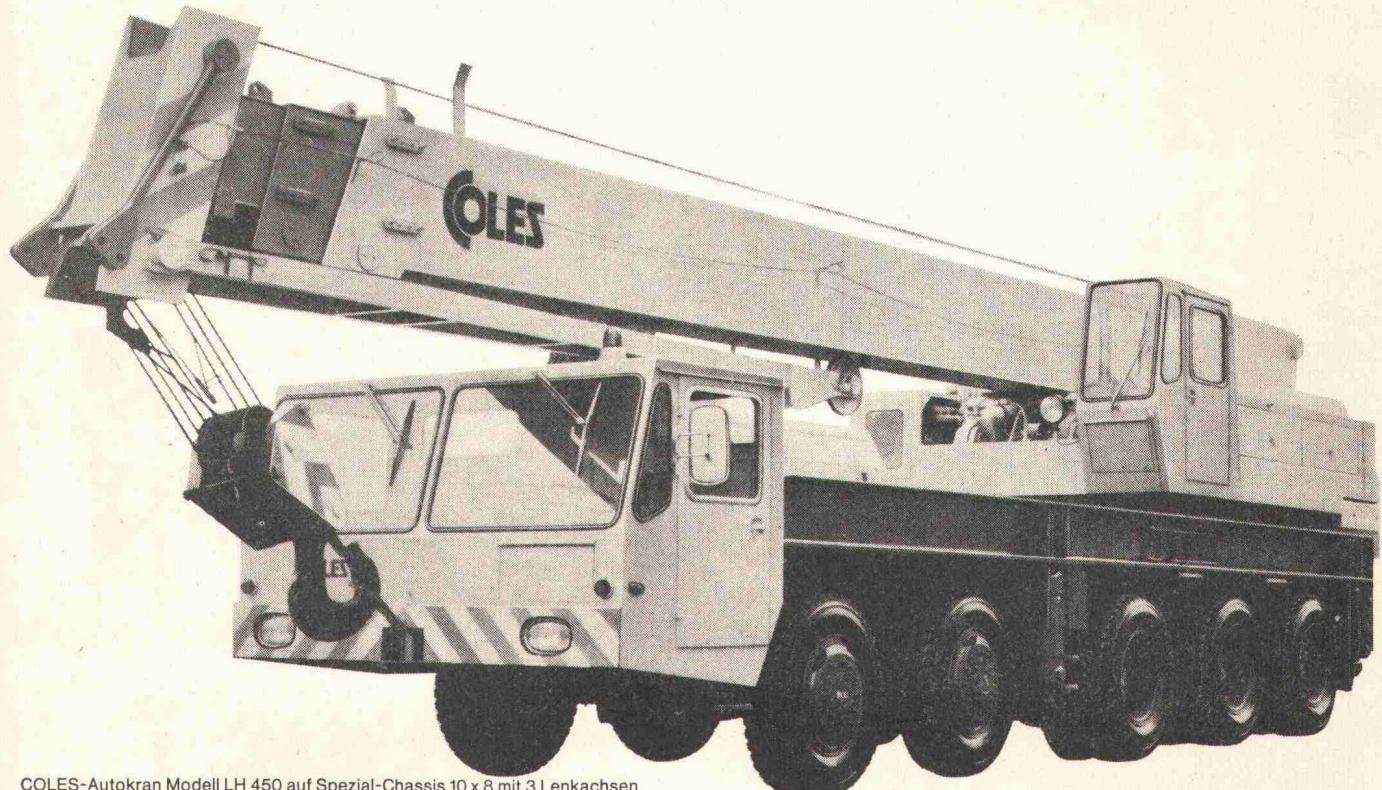
COLES-Autokran Modell LH 450 auf Spezial-Chassis 10 x 8 mit 3 Lenkachsen
