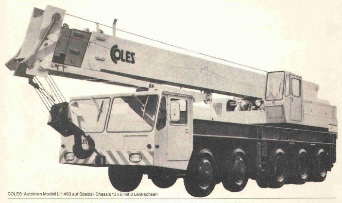
Dieselhydraulische COLES-Mobil- und Autokrane mit Teleskopausleger:
