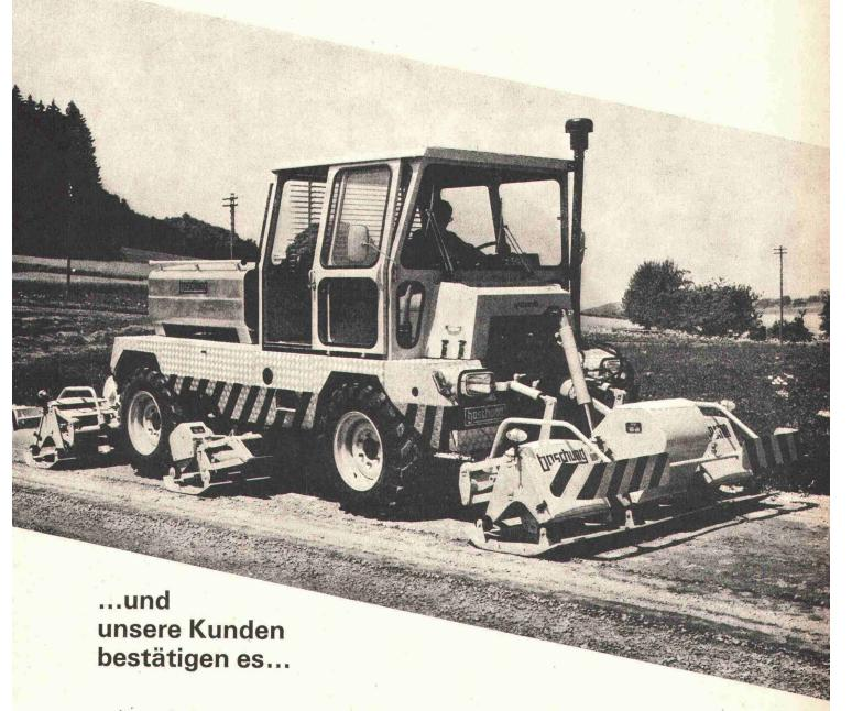
... besonders die hohen und gleichmässigen Verdichtungswerte sind für uns die massgeblichen Gründe, die BOSCHUNG-Mehrplattenverdichter bei der Verdichtung aller Schüttgüter einzusetzen. Die geringe Anzahl der erforderlichen Durchfahrten zur Erzielung der optimalen Verdichtungswerte wirkt sich auf Zeit und Kostensparung aus
