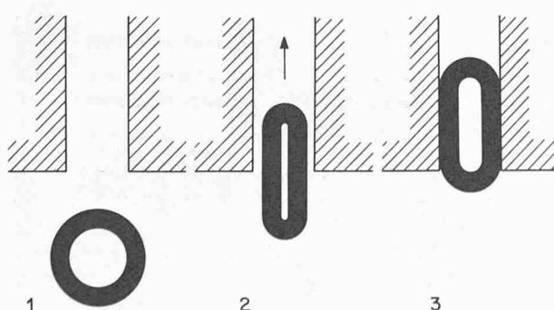
Vakuum-Fugendichtungen. 1 Das Dichtungsband im Normalzustand geschnitten. 2 Durch Ansetzen einer Vakumpumpe wird im Band ein Unterdruck erzeugt; das Kreisprofil wird flach. 3 Einmal in die abzudichtende Nut eingesetzt, wird das Vakuum aufgehoben und das Profil passt sich – dank seiner Elastizität – der Nut an und dichtet sie.
