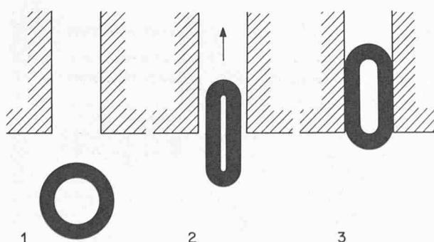
Vakuum-Fugendichtungen. 1 Das Dichtungsband im Normalzustand geschnitten. 2 Durch Ansetzen einer Vakuumpumpe wird im Band ein Unterdruck erzeugt; das Kreisprofil wird flach. 3 Einmal in die abzudichtende Nut eingesetzt, wird das Vakuum aufgehoben und das Profil passt sich – dank seiner Elastizität – der Nut an und dichtet sie.
