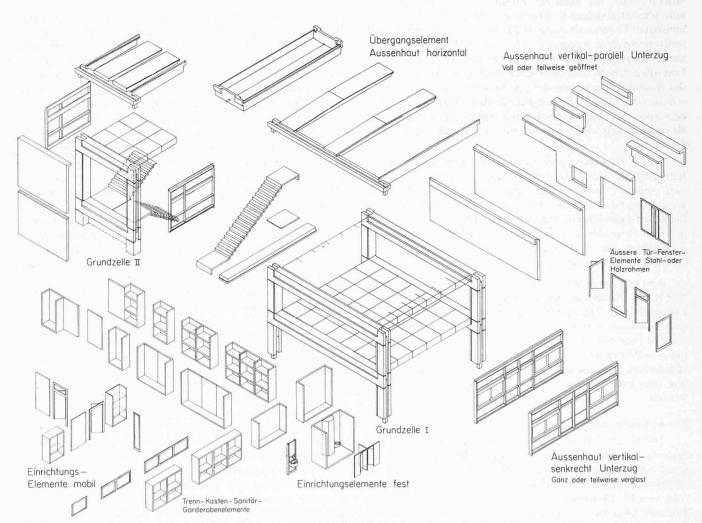
Ein Bausystem besteht aus typisierten Elementen mit denen verschiedenartigste Grundrisse und Gebäudeformen erstellt werden können
