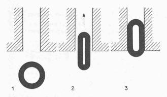
Vakuum-Fugendichtungen. 1 Das Dichtungsband im Normalzustand geschnitten. 2 Durch Ansetzen einer Vakuumpumpe wird im Band ein Unterdruck erzeugt; das Kreisprofil wird flach. 3 Einmal in die abzudichtende Nut eingesetzt, wird das Vakuum aufgehoben und das Profil passt sich – dank seiner Elastizität – der Nut an und dichtet sie
