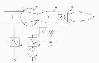
Bild 1. Prinzipschema des Emulsionsbrenners von Cuénod
