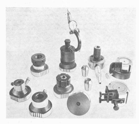
Bild 1. Verschiedene Ausführungen von Elektrodenhaltern
