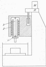
Bild 5. Elektrothermisches Vorschubsystem
