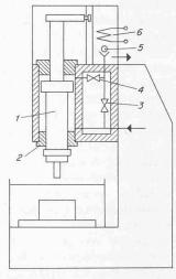
Bild 9. Elektrohydraulisches Vorschubsystem von Charmilles 1 Pinole, 2 hydrostatisches Lager, 3 und 4 Blenden, 5 Servo-
