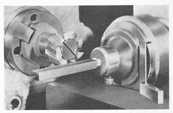
Bild 2. Bearbeitung einer Elektrode in einem Elektrodenhalter
