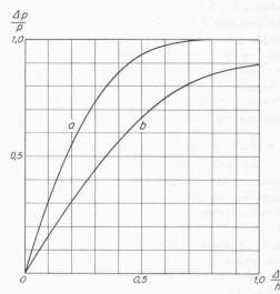
Bild 13. Verhältnismässige Druckerhöhung  $\triangle p/p$  [Gl. (1)] in Abhängigkeit von der verhältnismässigen Verschiebung  $\triangle h/h$  des Kolbens, a für ein Lager nach Bild 11, b für ein konventionelles hydrostatisches Lager
