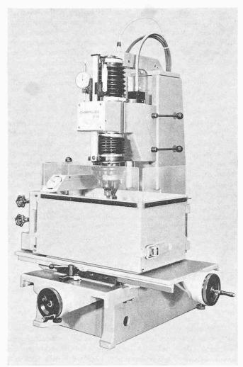
Bild 14. Funkenerosions-Werkzeugmaschine Charmilles D 10
