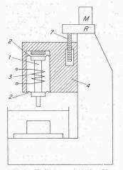
Bild 4. Elektromagnetisches Vorschubsystem
