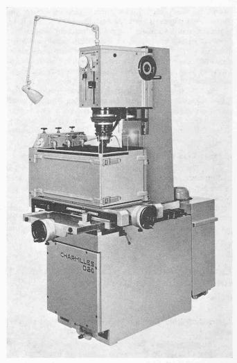
Bild 15. Funkenerosions-Werkzeugmaschine Charmilles D 20
