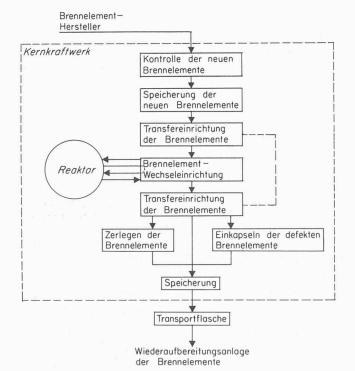
Bild 1. Schema der Brennelementhandhabung
