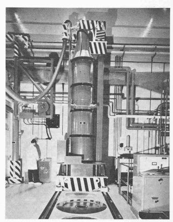
Bild 7. Transportflasche für Brennelemente in der Anlage Lucens
