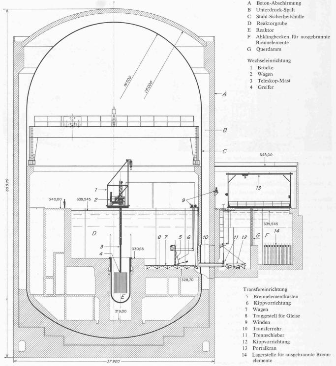
Bild 2. Brennelement-Handhabungseinrichtung im Kernkraftwerk Beznau der NOK
