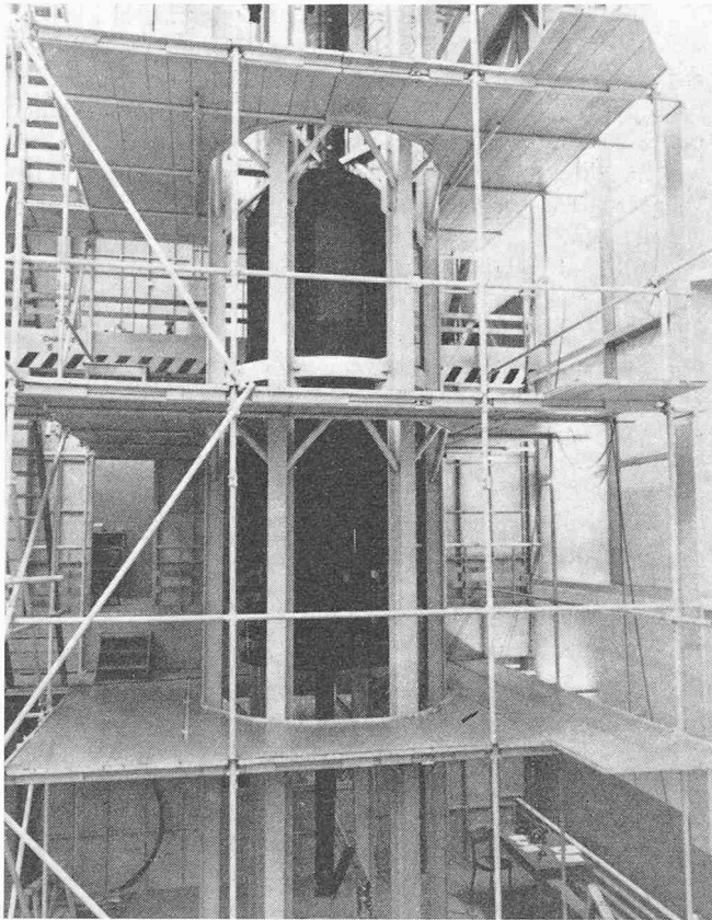
Bild 6. Wechseinrichtung der Anlage Dragon während den Werkstattversuchen; am unteren Ende des Schwenkarms ist der Greifer ersichtlich
