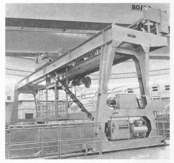
Bild 5. Wechseleinrichtung für Brennelemente im Kernkraftwerk Mühleberg
