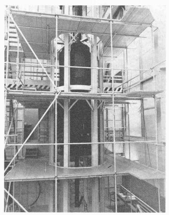
Bild 6. Wechseleinrichtung der Anlage Dragon während den Werkstattversuchen; am unteren Ende des Schwenkarms ist der Greifer ersichtlich
