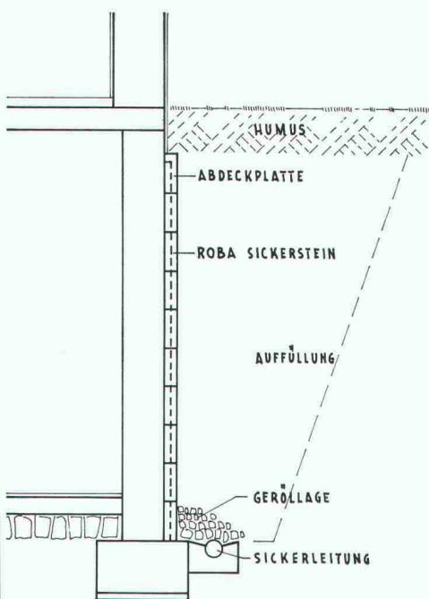
Typen: Sickerstein und Abdeckplatte
