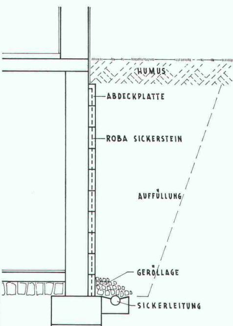
Typen: Sickerstein und Abdeckplatte
