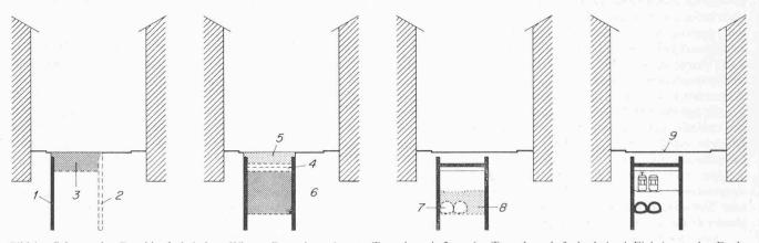
Bild 1. Schema des Bauablaufs bei der «Wiener Bauweise». 1 erste Tunnelwand, 2 zweite Tunnelwand, 3 Aushub, 4 Einbringen der Decke, 5 Zuschütten und provisorische Strasseninstandstellung, 6 Aushub bis zur Kanalsohle, 7 Einbringen des Kanalprofils, 8 Anschütten und Gleisarbeiten, 9 Erneuerung der Strassendecke (Quelle: Ellinger, M., «Strasse, Brücke, Tunnel» 21 [1969], H. 10, S. 261–264)
