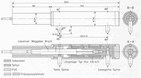
Bild 3. Ansicht und Schnitte des induktiven Setzdehnungsmessgerätes
