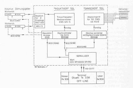
Bild 6. Schematischer Aufbau der elektronischen Mess- und Datenerfassungsanlage des Institutes für Baustatik der ETH Zürich
