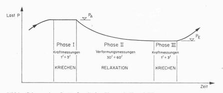
Bild 1. Schema einer Laststufe mit den Phasen I, II und III
