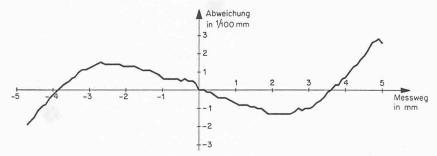
Bild 4. Linearitätsabweichung eines induktiven Setzdehnungsmessgerätes
