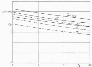
B ld 24. Maximaler Drehzahlanstieg  $x_m$  in Abhängigkeit von der Anlaufzeit  $T_A$  und der Füllzeit  $T_H$  des Hochdruckteils; gestrichelt: mit Störgrössenaufschaltung  $(k_x=25,\ k\psi=10,\ q=2)$
