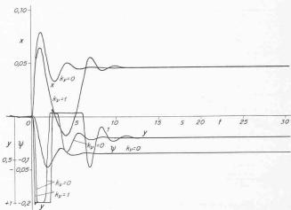
Bild 19. Regelvorgang mit  $T_A=6.5$  s,  $T_H=15$  s, q=2,  $k_x=25$  und  $k\psi=10$  ohne und mit Störgrössenaufschaltung
