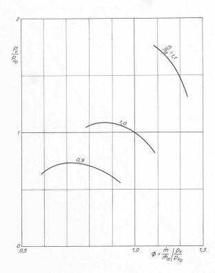
Bild 6. Leistungskennfeld des gesamten Verdichters  $(P_{V0} = 36,16 \text{ kcal/kg})$
