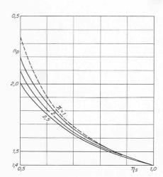
Bild 2 (links). Polytropen-Exponent  $n_p$  in Abhängigkeit vom isentropen Wirkungsgrad  $\eta_s$  und dem Druckverhältnis  $\pi$ ; gestrichelt: nach Gl. (8) für  $\pi \to 1$
