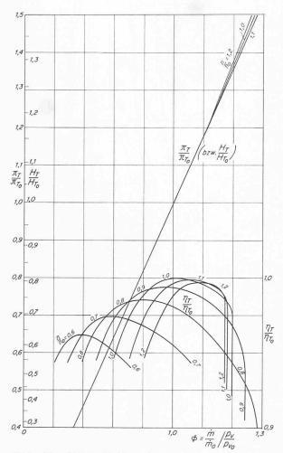
Bild 8. Kennfeld der Turbine mit  $\Phi$  als Abszissenachse
