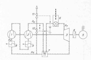
Bild 1. Vereinfachtes Schaltbild einer Heissluft-Turbinenanlage
