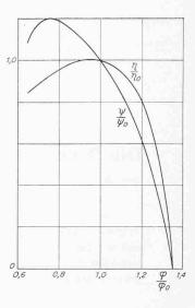
Bild 3 (rechts). Stufenkennlinie eines Axialverdichters nach Eckert und Schnell [10]
