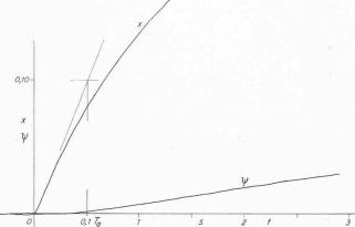
Bild 16. Übergangsfunktion der Strecke mit  $T_A=5\,\mathrm{s}$  und  $T_H=15\,\mathrm{s}$
