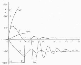
Bild 17. Regelvorgang für  $T_A=6.5\,\mathrm{s}$ ,  $T_H=20\,\mathrm{s}$ , q=1,  $k_x=50\,\mathrm{und}$   $k\psi=0$  ohne Störgrössenaufschaltung. Die Dämpfung ist schlecht (oR: ohne Regler, also Übergangsfunktion der Strecke)
