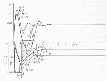
Bild 21. Regelvorgang für  $T_A=6.5$  s,  $T_H=20$  s, q=2,  $k_x=25$  und  $k\psi=10$  (gegenüber Bild 20 ist also nur q=2= const) ohne und mit Störgrössenaufschaltung durch ein Lastabwurfrelais und einen Beschleunigungsregler
