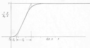
Bild 15. Übergangsfunktion des Reglers mit  $T_u=0.08\,\mathrm{s}$  und  $T_s=0.20\,\mathrm{s}$
