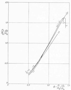
Bild 9. Leistungskennfeld der Turbine ( $P_{T0} = 66,15 \text{ kcal/kg}$ )
