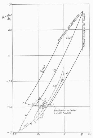
B.ld 12. Änderung des Momentes der Nutzleistung, durch welches das Aggregat beschleunigt wird (wegen der dünn eingetragenen Kurven s. Text zu Bild 23, nicht Bildunterschrift)
