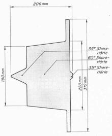
Bild 1. Querschnitt durch das GINA-Profil
