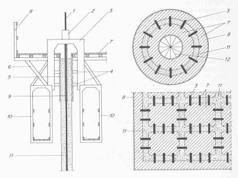
Bild 1. Links Schemaschnitt durch die Gleitschalung, rechts Anordnung der Gerüstjoche im Grundriss, kreisförmiges Bauwerk (oben) und Zellensilo (unten). 1 Kletterstange, 2 Heber, 3 Gerüstjoch, 4 Rahmenholz, 5 Schalung aus Stahlblech, Holz oder aus blechbeschlagenem Holz, 6 Verstrebung des Kraggerüstes, 7 Arbeitsplattform, 8 Geländer, 9 Mantelrohr, 10 Hängegerüst, 11 Beton, 12 Seilverspannung
