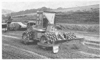
Bild 1. Einsatz des Cat-Verdichters 815 auf der N 12. Mit dem Schaufelblatt kann der Verdichter das Schüttmaterial selbst verteilen und ausgleichen
