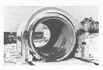
Bild 2. Das rechte Seitenteil der «Krake» trägt die Hydraulikpumpe, den Elektromotor, Tank, Kabeltrommel und den Bedienungsstand
