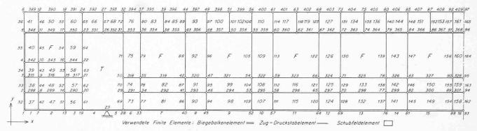
Bild 13. Zur Berechnung mit Finiten Elementen idealisierter Leichtstahlwagen: Die idealisierte Struktur des Wagens weist bei Ausnutzung der Symmetrie eine Knotenzahl von 97, mit 236 Freiheitsgraden und 223 Elementen auf
