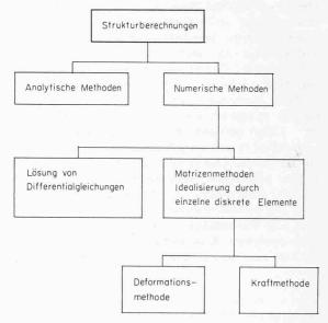
Bild 1. Methoden der Strukturberechnung
