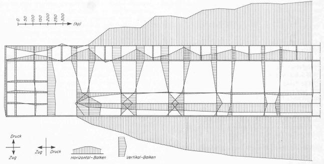
Darstellung der Ergebnisse (vertikaler Lastfall): Verlauf der Kräfte in den Zug-Druckelementen über den Wagenkasten Bild 15 A.
