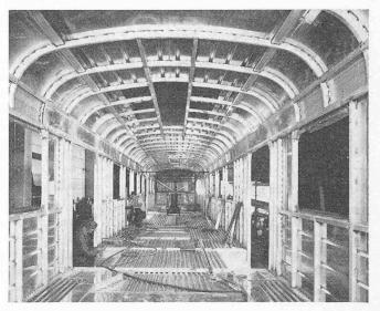
Bild 5. Differentialbauweise: NSB-Leichtmetallwagen eines Vorortszuges (Photo Alusuisse)
