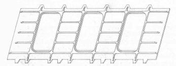
Bild 3. Integralbauweise. Gefräste Fensterrahmenkonstruktion des Überschallverkehrsflugzeuges «Concorde»
