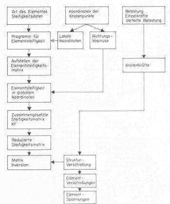
Bild 8. Flussdiagramm der Deformationsmethode. Möglicher Ablauf eines Computerprogramms für Finite Elemente
