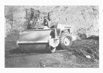
Bild 8. Selbstfahrende Tandem-Vibrationswalze Dynapac CC 40 mit Knicklenkung und fünf verschiedenen Amplituden-Stufen für Erdund Asphaltverdichtung, Gewicht 10 200 kg, mit Deutz-Dieselmotor von 92 PS Alle Bilder sind Werkphotos Notz & Co. AG, Biel.
