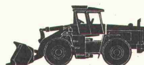
Radlader Europ KL 30 Motor: 240 SAE-PS Schaufeln: 2,5–4,8 m 3 Gewicht: 17200 kg
