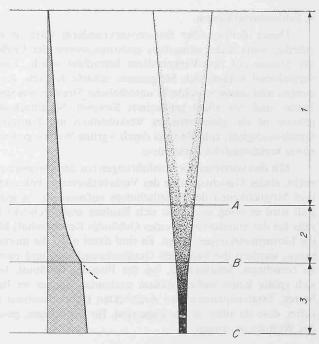
Bild 1. Graphische Darstellung der Drucksteigerung mit Druckbegrenzung in der Nachpressphase (links) und des Aufbaus der Feststoffschichten (rechts)
