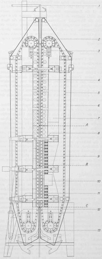
Bild 2. Schematischer Aufbau der Schlammentwässerungspresse
