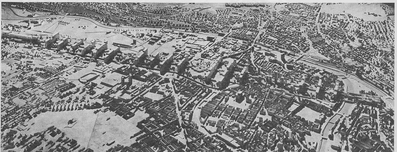
Bild 4. Vorschlag einer «Wohn-City» über dem Gleisareal des Hauptbahnhofes Zürich, welcher im Oktober 1971 dem Stadtrat von Zürich von der «Stadtplanungsgemeinschaft Guhl/Barbe/Heierli» unterbreitet wurde. Länge 4 km, Breite 250 m, Wohnraum für 60000 Personen bei teilweiser Durchsetzung mit Büros und Geschäften. Das Infrastruktur-Sockelgeschoss in 12 m Höhe über den Gleisen enthält eine Expressstrasse und Parkräume sowie alle Werkleitungen und ist auf der Oberfläche als durchgehender Park ausgestaltet
