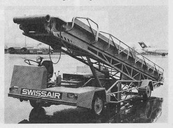
plattform aufweisen, siehe Bild 10. Die oberste Plattform kann seitlich um 30° geschwenkt werden, so dass sie einer allfälligen Schrägstellung der Türöffnung angepasst werden kann. Eine Neuerung stellt die vertikale Verstellmöglichkeit der oberen Plattform dar; deren Höhe kann verstellt werden, ohne die Lage der ganzen Treppe anpassen zu müssen.
