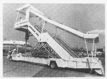
Bild 10. Prototyp der neuen fahrbaren Passagiertreppe. Die oberste Plattform kann bis auf rund 5,50 m gehoben und seitlich um 30 ° geschwenkt werden
