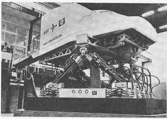
Bild 5. Flugsimulator mit sechs Freiheitsgraden für die Boeing 747. Er wurde in Amsterdam installiert und wird abwechslungsweise von der KLM, der SAS und der Swissair benutzt
