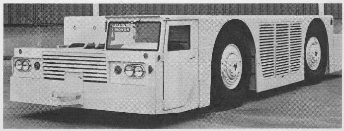
Fahrerkabine). Diese lässt sich um 0,45 m hydraulisch ausfahren, um dem Fahrer eine bessere Übersicht zu geben. Das Gewicht beträgt 60 t, mit zusätzlichem Balast 90 t.
