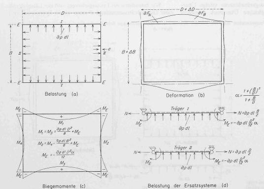
Bild 2. Belastung, Biegemomente und Deformation einer Rohrleitung mit rechteckigem Querschnitt
