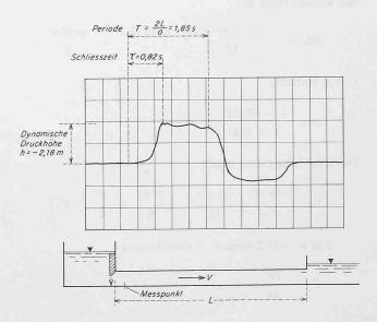
Bild 5. Druckstoss unterhalb des Abschlussorgans
