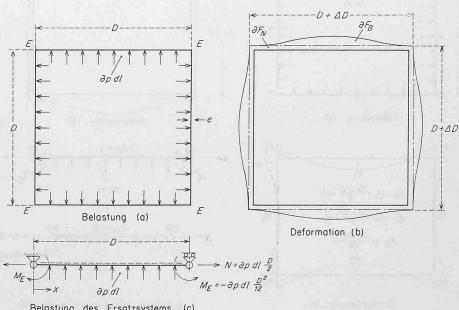
Bild 1. Belastung und Deformation einer Rohrleitung mit quadratischem Querschnitt
