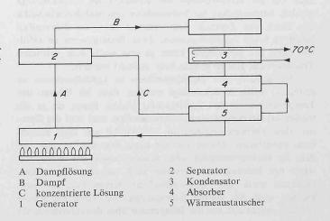
Bild 10. Prinzipschema des Gas-Klimagerätes im Heizbetrieb
