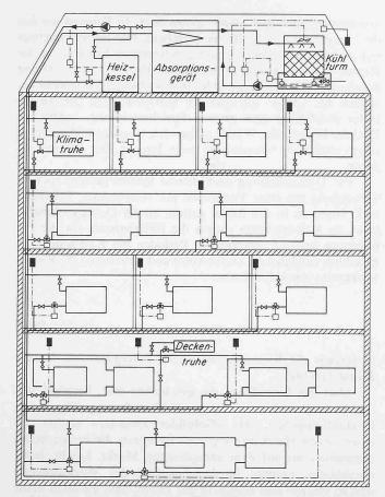
Bild 11. Installationsschema der Heiz-/Klimaanlage eines mittleren Kaufhauses in Deutschland. Die Anlage wurde ins Dachgeschoss eingebaut, da der Keller als Verkaufs- und Lagerraum benutzt wird. Es werden nur die Verkaufsräume klimatisiert, deshalb genügt die Kälteleistung von 45 000 kcal/h, während die Heizleistung insgesamt 130 000 kcal/h beträgt
