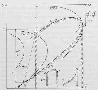
Bild 2. Darstellung der stehenden Detonationswelle im T, S-bzw. i, S-Diagramm. F Fannokurve, R Rayleighkurve
