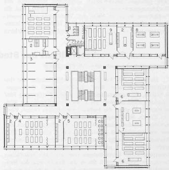
Zweites Obergeschoss 1:600. Legende: 1 allgemein bildende Fächer, 2 Material, 3 Elektro-Prüfungs- und Kursraum, 4 Damenschneiderinnen, 5 Coiffeure, 6 Elektromonteure, 7 Elektro-Demonstrationsraum, 8 Labor, 9 Drogisten und Laboranten
