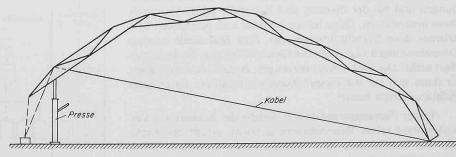
Bild 3. Montage einer Halle mit Pressen
