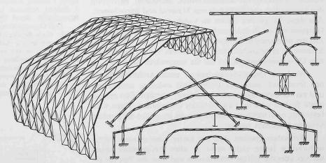
Bild 2. UFP-(Universal Folded Plate) Bauformen
