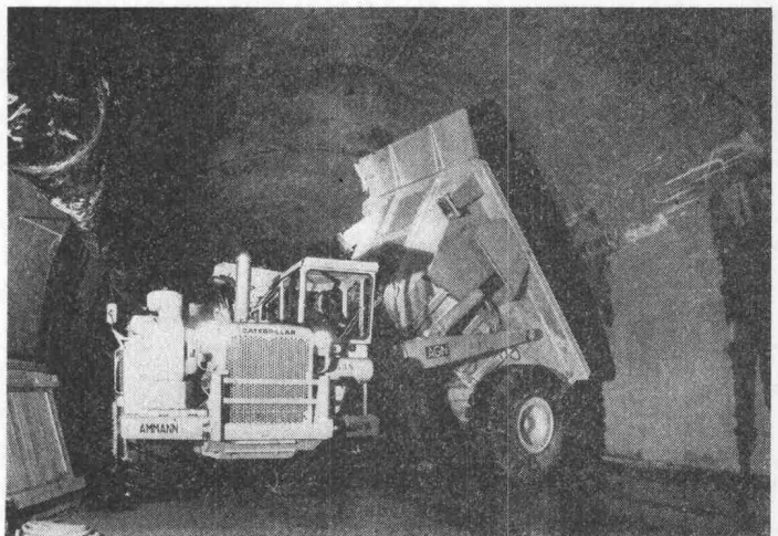
Bild 1. Durch Aufkippen der Benne verkürzt der Caterpillar-Rückwärts- kipper 621PR seinen Radstand, was ihm ein Wendemanöver auf den er- sten Antrieb ermöglicht
