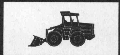
Radlader Europ L 1000 Motor: 120 SAE-PS Schaufeln: 1,1–1,8 m 3 Gewicht: 7800 kg
