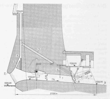
Bild 4. Beckenentleerungseinrichtung 1:400
