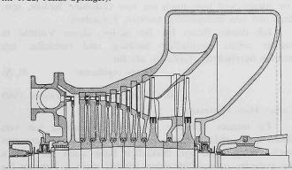
Bild 1. Baumann-Turbine mit zweifacher Ausströmung
