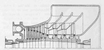
Bild 2. Baumann-Turbine mit vierfacher Ausströmung
