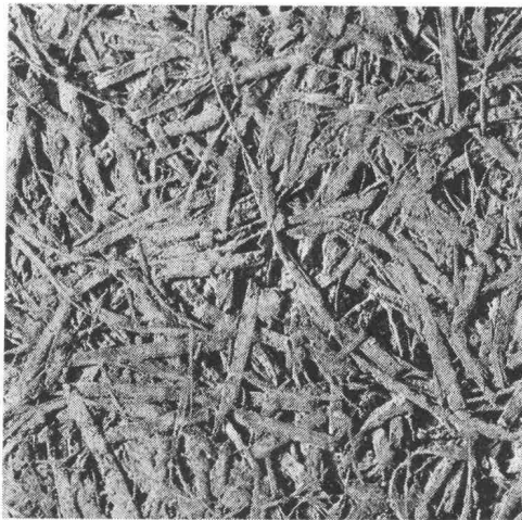
Struktur einer unbeschichteten Heraklith-Leichtbauplatte
