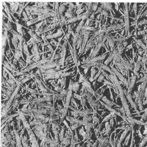
Struktur einer unbeschichteten Heraklith-Leichtbauplatte
