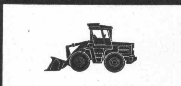
Radlader Europ L 800 Motor: 80 SAE-PS Schaufeln: 0,8–1,3 m 3 Gewicht: 5800 kg
