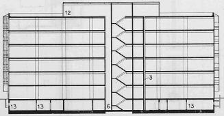
Längsschnitt Bürohaus 1:700, Legende: 3 Sanitärschacht, 6 Klimaschacht, 12 Maschinenraum, 13 Garderobe/Luftschutz
