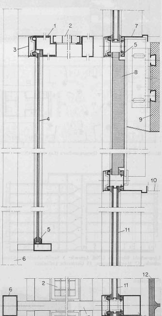
$B\ddot{u}rohaus$ . Einzelheiten: vorgehängte Fassade und Sonnenschutz; oben Vertikalschnitt, unten Horizontalschnitt
