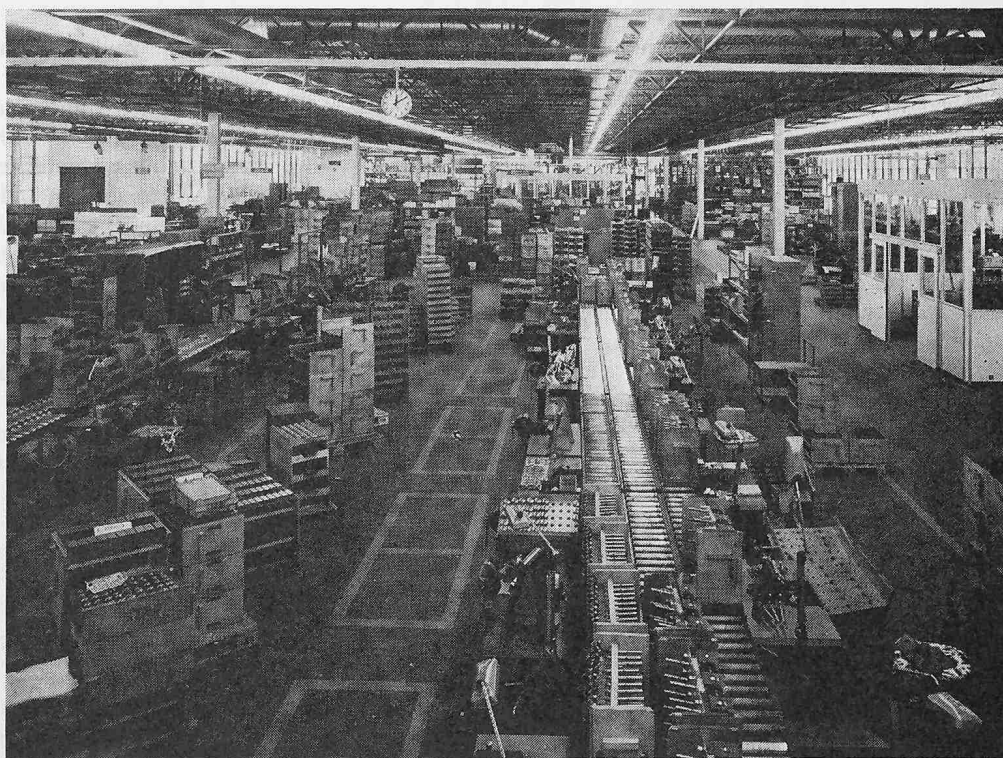
Produktionshalle (Obergeschoss, 9) mit Fließbandmontage der Texturermagnetspindel
