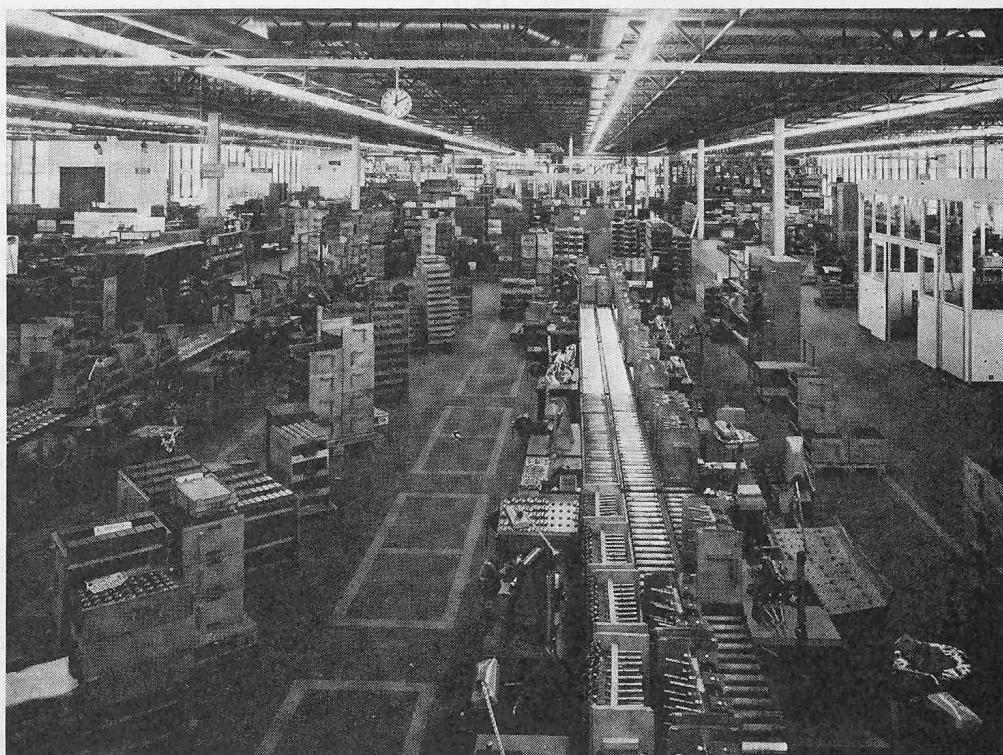
Produktionshalle (Obergeschoss, 9) mit Fließbandmontage der Texturermagnetspindel
