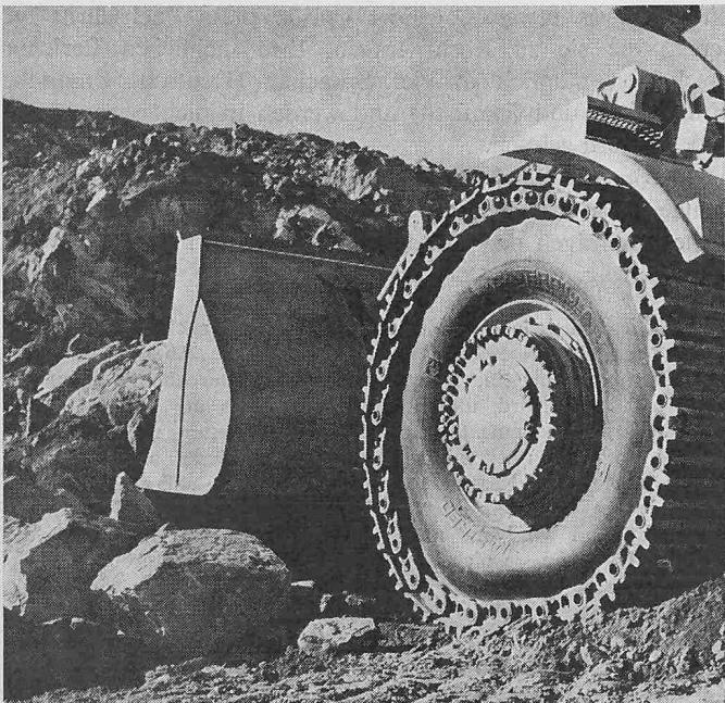
vier Kettengruppen, die jeweils auf ein aufgepumptes Gummirad montiert werden (Bild 1). Bei diesen Rädern handelt es sich nicht um Reifen, sondern um besonders für diesen Zweck konstruierte pneumatische Vorrichtungen. Das Gummirad ist auf ein Spezialrad montiert, welches einen festen Bestandteil der gesamten Gruppe bildet. DK 629.1.032
