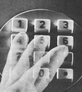
Unsere Tastenwahleinrichtung haben wir eigens für die Haustelephonzentrale ESK 8000 entwickelt. Elektronik und Edelmetall-Schnellkontakt-(ESK) Relais arbeiten mit hoher Geschwindigkeit Hand in Hand.
