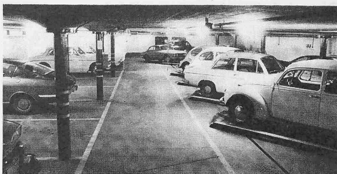
Bild 4. Abfahren. Die Plattform steht mit 45° schräg zur Fahrbahn; es kann vorwärts ausgefahren werden
