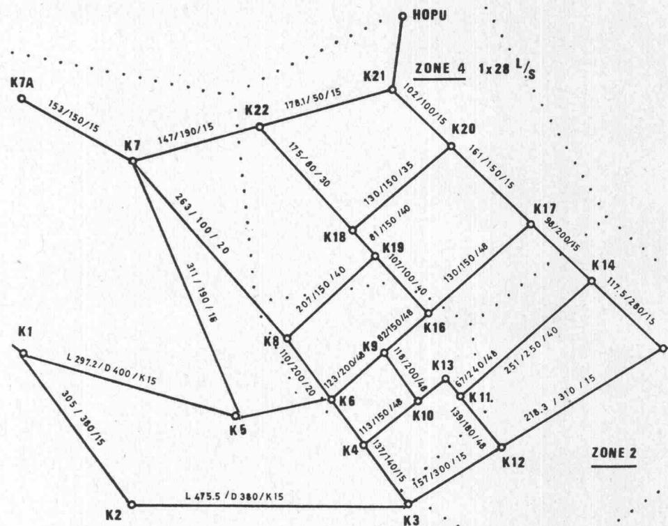
AQUANET ist ein Programm zur Berechnung von Druckwasserleitungen. Auf der Grundlage des Fliessgesetzes von Darcy und den Beziehungen von Hagen-Poiseuille für laminares bzw. Colebrook für turbulentes Fliessen werden die nicht-linearen Gleichungen des Netzes aufgestellt und iterativ aufgelöst. Es können praktisch beliebig grosse Leitungsnetze mit beliebigen Pumpen, Hydranten, Reservoirer und Schiebern berechnet werden.
