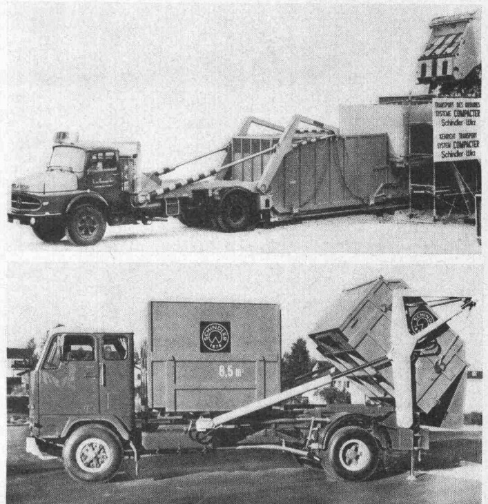
Bild 2. Schwenklader Schindler-Wirz mit zwei 8,5-m 3 -Kehrrechtcontainern für lose Schüttung und Einfüllöffnungen auf dem Dach
