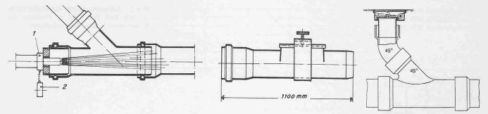
Bild 9. Links: Spülstutzen für die Reinigung der Sammelleitung. 1 Spülschlauch (Feuerwehrschlauch), 2 Storz-Kupplungsdeckel; Mitte: Formstück mit Kontroll- und Putzverschluss; rechts: Anordnung eines Reinigungs- und Spülschachtes in der Fahrbahn
