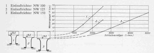
Bild 2. Schluckvermögen der Einlauftrichter von Roll Fig. 4533 in Funktion des Wasserspiegels über Seiheroberkante
