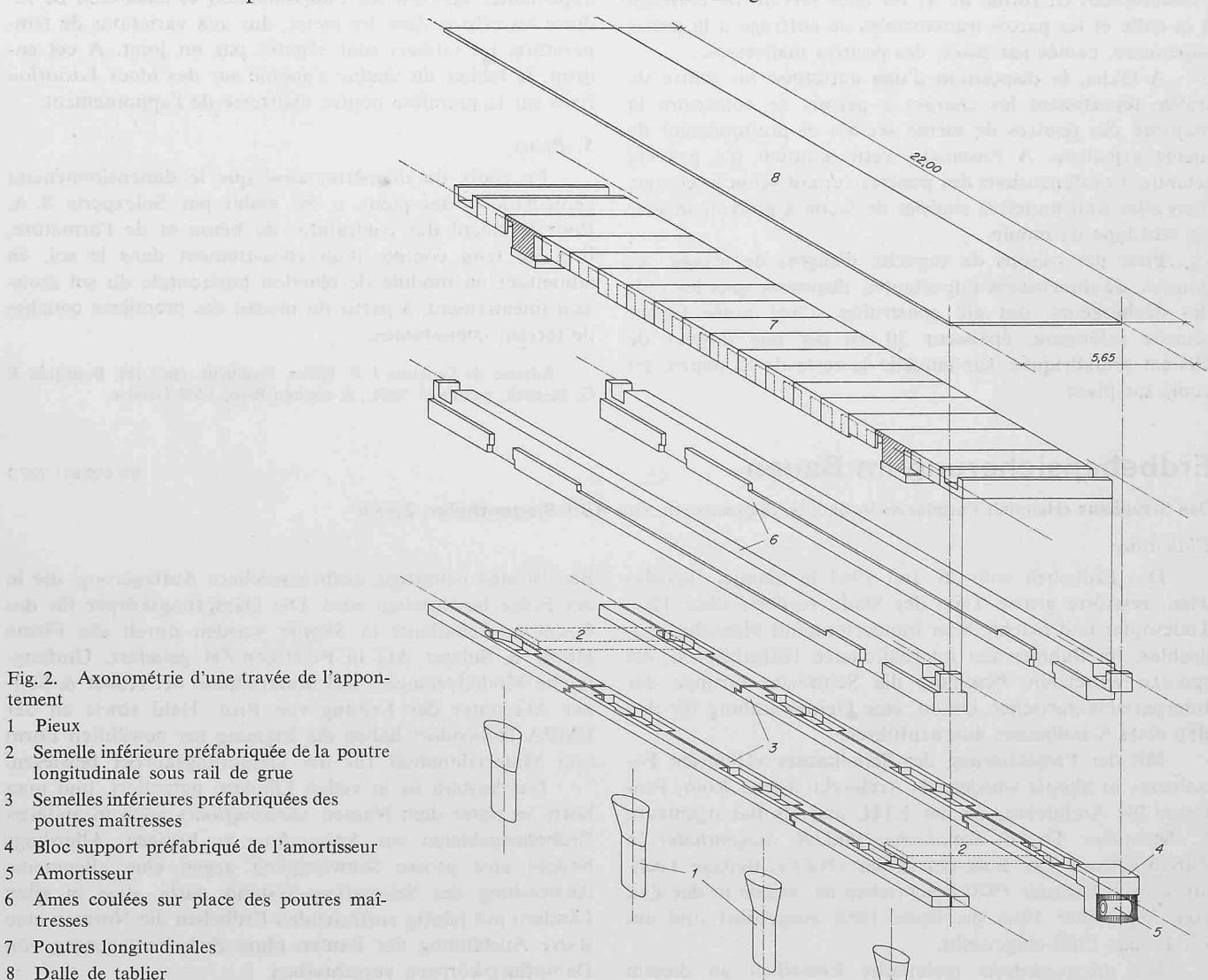
Fig. 2. Axonométrie d'une travée de l'appontement
