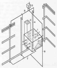
Bild 3. Schematische Perspektivdarstellung des Kühlsystems beim Brandversuch
