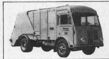
4) FBW L 35 U: Kehrrichtwagen Motor: FBW CU (130 PS) Getriebe: Allison MT-41 (Automat)
