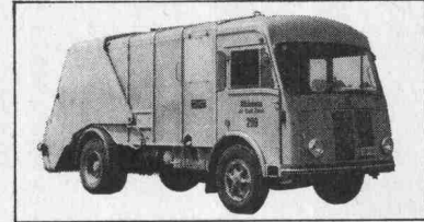
4) FBW L 35 U: Kehrichtwagen Motor: FBW CU (130 PS) Getriebe: Allison MT-41 (Automat)
