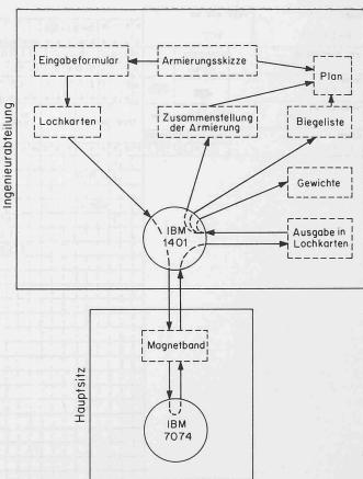
Bild 5. Informationsfluss zwischen Ingenieurabteilung und Hauptsitz beim Entwurf der Armierung
