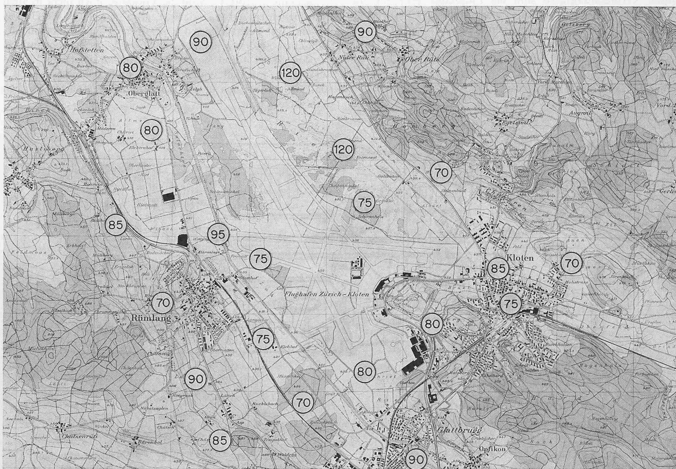
Bild 2. Mittlerer Staubbiederschlag in mg/m 2 · Tag in der Umgebung des Flughafens Zürich-Kloten. Messzeit 2. Juli bis 8. November 1968. Kartenmassstab 1:50 000 (Veröffentlicht mit Bewilligung der Eidg. Landestopographie vom 1. Dezember 1970)
