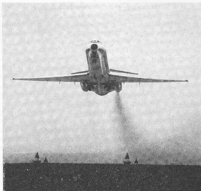
Bild 6b. Abfliegende Douglas DC-9. Das rechte Triebwerk ist mit raucharmen Brennkammern ausgerüstet
