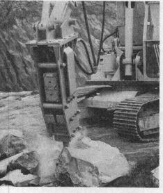
Herr Meyer setzt den Hydraulik-Hammer HM 400 ein — ein echtes Allroundgerät. Der leistet beim Aufreißen, Abbrechen, Zertrümmern, Knäppern oder Verdichten die Arbeit von 15 manuellen Hämmern. Er weiß, daß er mit dem HM 400 nicht nur 15 Mann Personal, sondern auch 15 Hämmer und deren Wartungskosten spart.
