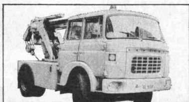
1) Berliet: Kran- und Schleppwagen Motor: GM-Diesel 6V-53 (182 PS) Getriebe: Allison MT-41 (Automat)
