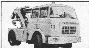
1) Berliet: Motor: GM-Diesel 6V-53 (182 PS) Getriebe: Allison MT-41 (Automat)
