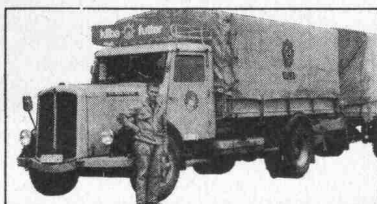
2) Saurer: Motor: Cummins 8V-185 Getriebe: Allison MT-41 (Automat)
