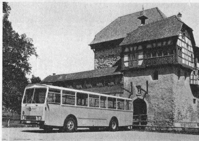
Bild 2. Kurswagen Typ 5 DUK mit Unterflurmotor von 215 PS
