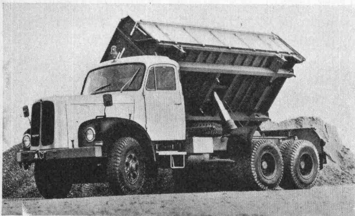
Bild 1. Dreiachsiger Kipper von 26 t Gesamtgewicht Typ 5D 6×4
